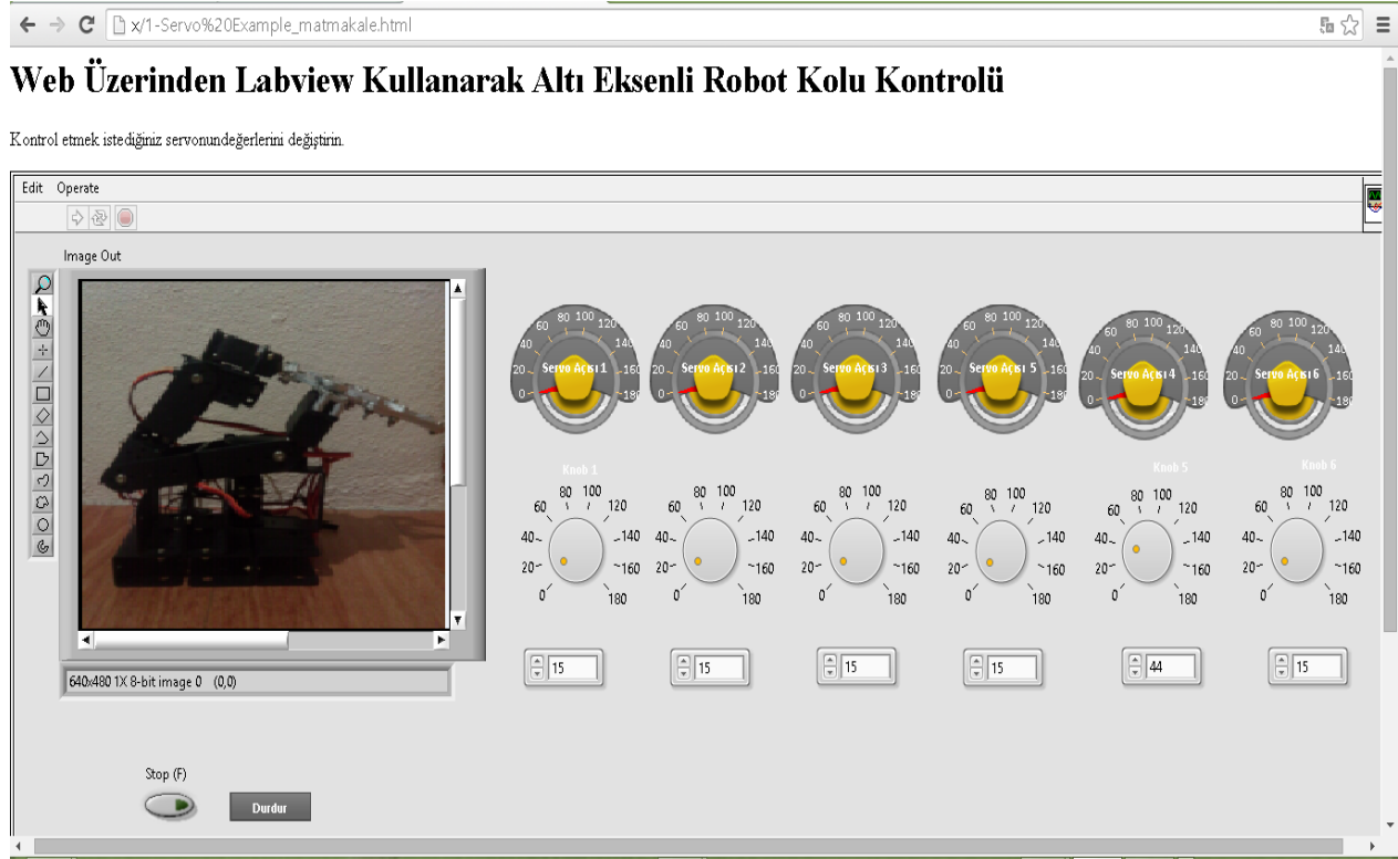
Şekil 4. Robot kolunu kontrol etmek için oluşturulan web ara yüzü.
