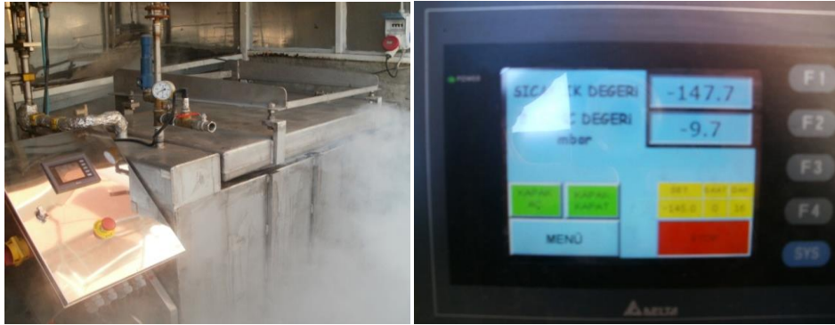
Şekil 4. Kriyojenik işlem fırını ve sıcaklık-basınç göstergesi
