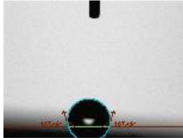
Şekil 3.5. Zn metali ile modifiye edilmiş yüzeyin temas açısı ( 147^\circ )
