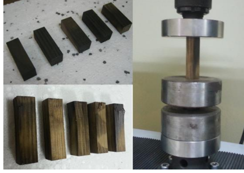
Şekil 8. Bakır oksit nano Parçacık emprenye edilmiş paralel basınç deney düzeneği ve numuneleri 7 numune gurubundan paralel basınç deneyi sonucunda elde edilen yük-sehim (N - mm) değerleri, gerilme-birim deformasyon (MPa - %) değerlerine dönüştürülmüştür ve sonuçlar tablo halinde verilmiştir (Tablo 3).
