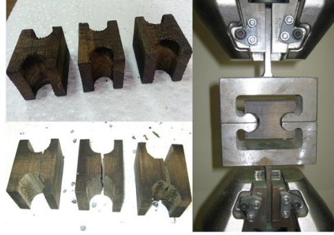
Şekil 6. Bakır oksit nano Parçacık empenye edilmiş dik çekme deney düzeneği ve numuneleri
