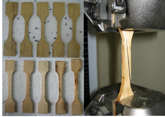
Şekil 1. Bor oksit nano Parçacık emprenye edilmiş paralel çekme deney düzeneği ve numuneleri
