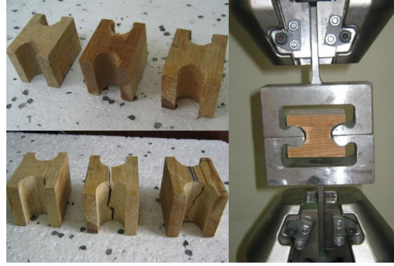
Şekil 3. Bor oksit nano Parçacık emprenye edilmiş dik çekme deney düzeneği ve numuneleri
