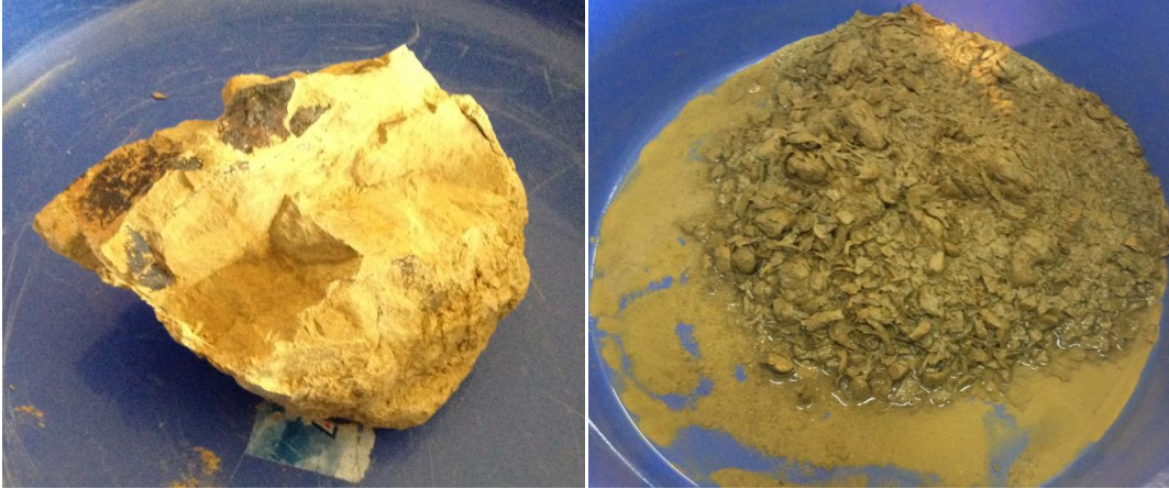
Foto 4. Dolgudan alınan bloğun kuru ve suda bekletilmiş hali
