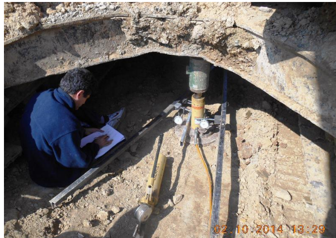
Foto 6. Alanda yapılmış plaka taşıma deneyi
