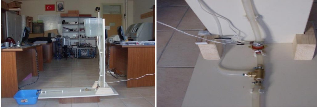
Şekil 10. Taşkın önleme sistemi deneme uygulaması, şebeke girişini temsil eden hattaki valf ve sensör
