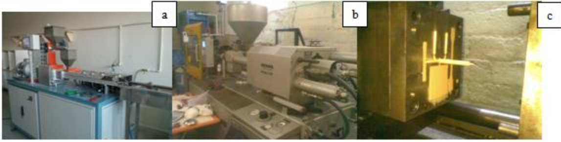
Şekil 1. a) Ekstrüzyon makinesi, b) Enjeksiyon makinesi, c) Numuneler ve üretildikleri kalıp.
