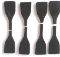
Şekil 3. Çekilmiş TS 1398-2 standart test numuneleri
