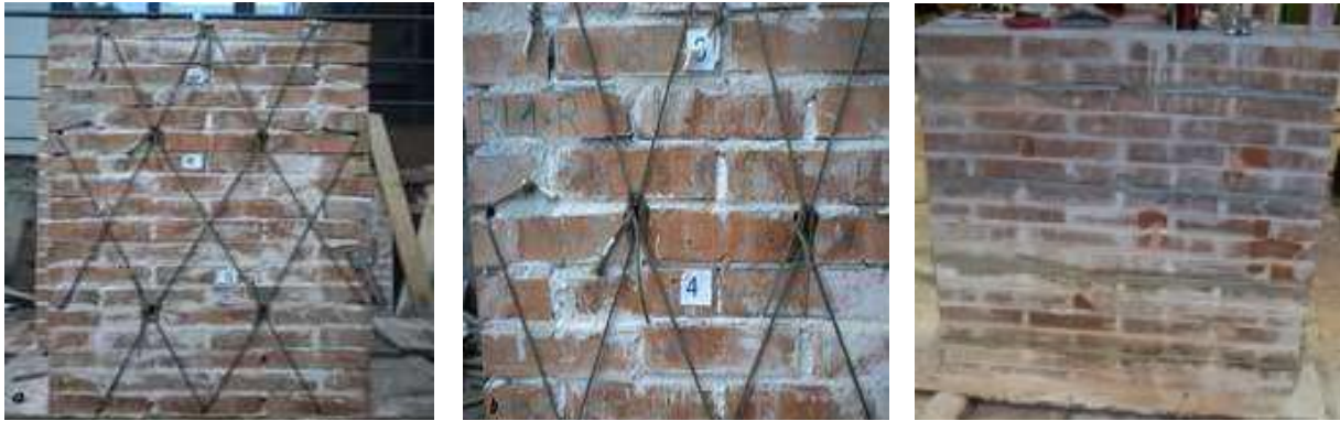
Şekil 7. Bazalt halat ile baklava ve şerit şeklinde güçlendirme [20-21]
