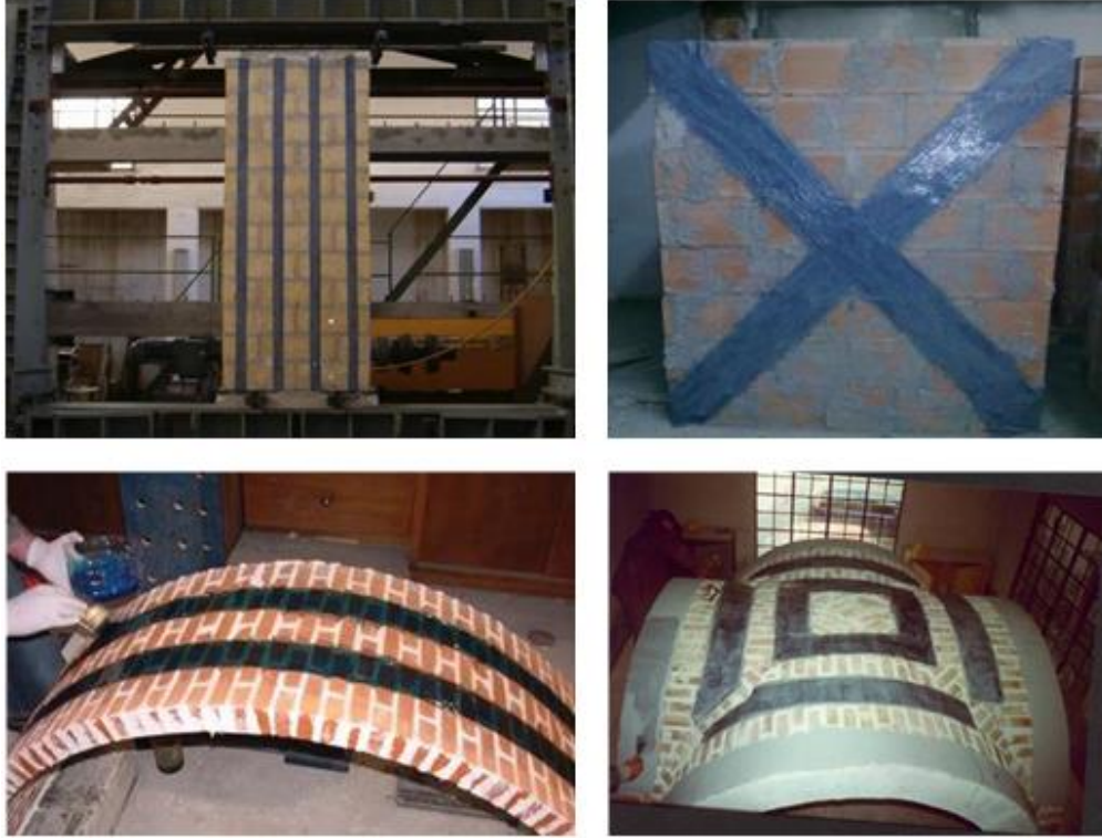
Şekil 5. Karbon şeritlerin güçlendirmede kullanılması [13-16]
