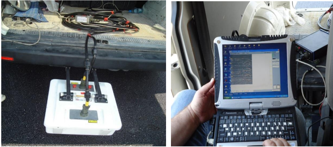
Şekil 1. Arazi aracına monte edilmiş GPR sistemi ve PC'ye anlık veri aktarımı (Serin, 2014)
