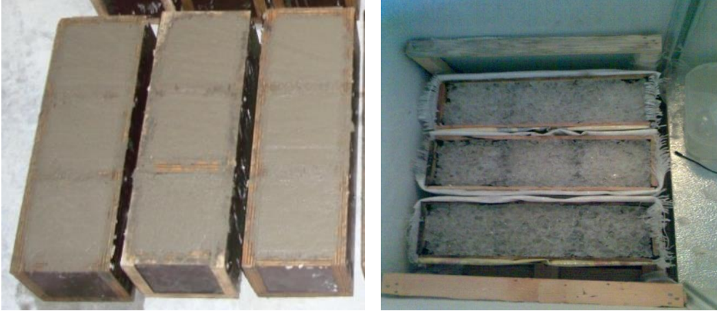
Şekil 1. Derin dondurucudan çıkartılan numuneler tuz serpilerek erimeye bırakılmış hali
